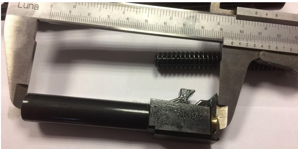
Rysunek 10 - Długość lufy wraz z komorą naboju i wprowadzonym nabojem 9mm PARA – 95mm
