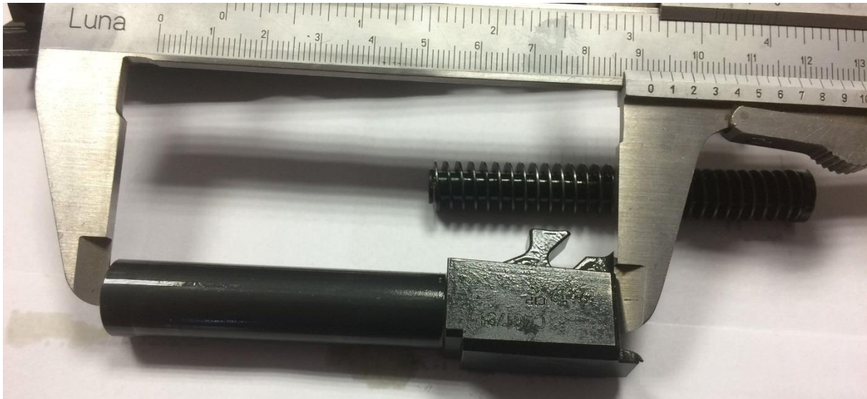
Rysunek 9 - Długość lufy wraz z komorą naboju – 91mm
